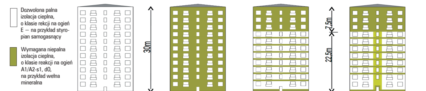
Budynek mieszkalny 11-kondygnacyjny o wysokości 30 m, wzniesiony przed 1 kwietnia 1995 r. docieplany izolacją cieplną o grubości 150 mm
