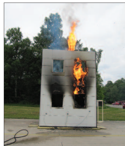
Fot. 1. Badanie systemu ETICS z EPS według procedury LEPIR
