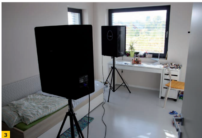
FOT. 1–3. Dom w Zielonkach. Badanie izolacyjności akustycznej ścian wewnętrznych i zewnętrznych z wełną mineralną w domu pasywnym; fot.: Isover
